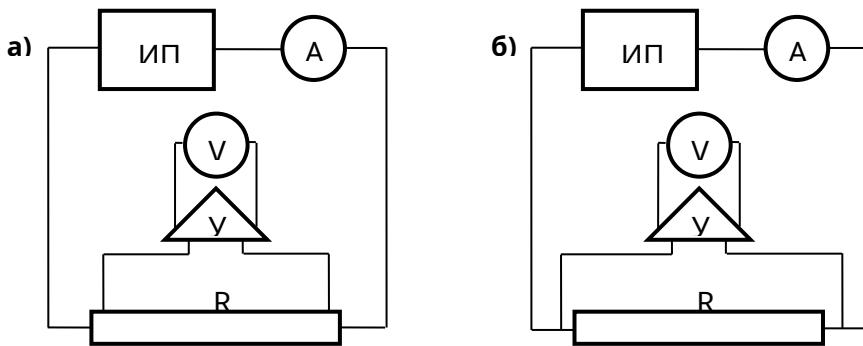
Рис.1. Принципиальная электрическая схема установки. ИП – источник питания, А – амперметр, В – вольтметр, У – измерительный усилитель, R – исследуемый образец с малым сопротивлением.
